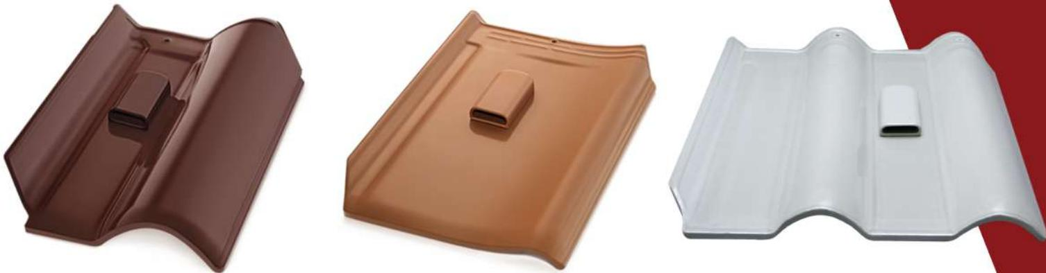
**La instalación** debe ser "aleatoria", espaciando las tejas ventiladas cada 1,50 o 2,00m entre sí, según la intención de ventilación, a intervalos con las tejas cerámicas.
