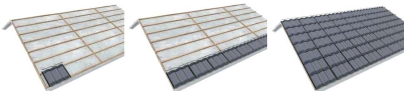
Para acabado lateral, superior o inferior del tejado puede ser usado las **tejas auxiliares**, fabricadas en cerámica, del mismo color e insertos laterales. Se utilizan **3 Tejas Auxiliares por cada Teja Solar**.
